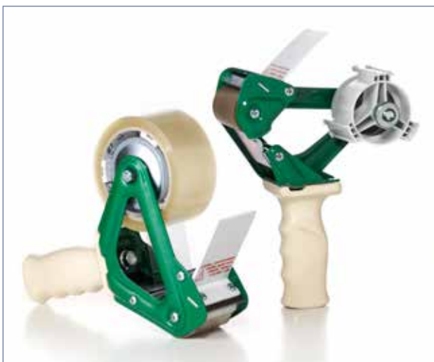
Artikel 697 - stabil metaldispenser, ergonomisk håndtag, variabel tapebremse, egnet til tape med 76 mm kerner diameter og rullelængder på 66 m, 132 m og 180 m
