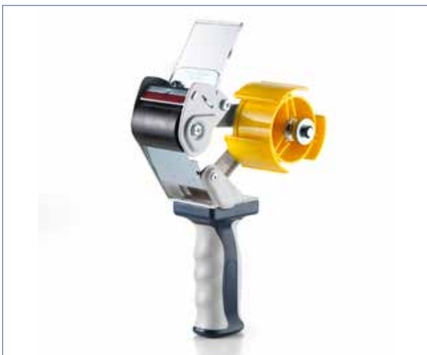
Artikel 79071 - stabil metaldispenser, ergonomisk håndtag med gummibelagt greb, variabel tapebremse, aktiv knivbeskyttelse (Touchflap), Twincore, egnet til tape med 76 mm kerner diameter såvel som rullelængder på 66 m, 132 m og 180 m
