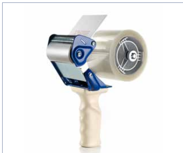
Artikel 16207 - stabil metaldispenser, ergonomisk håndtag, variabel tapebremse, egnet til tape med 76 mm kernediameter og rullelængder på 66 m, 132 m og 180 m
