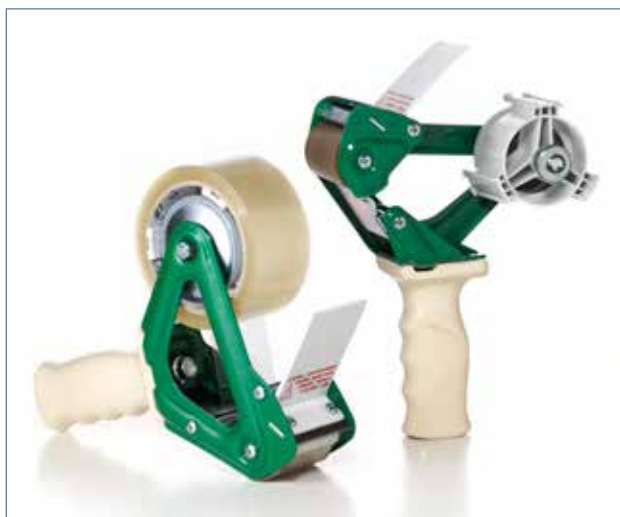
Artikel 697 - stabil metaldispenser, ergonomisk håndtag, variabel tapebremse, egnet til tape med 76 mm kernediameter og rullelængder på 66 m, 132 m og 180 m
